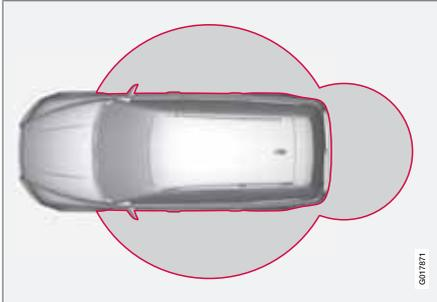
Con la función "keyless drive" del PCC, el automóvil puede abrirse, conducirse y cerrarse sin llave. Basta con llevar el PCC encima. El sistema permite abrir el automóvil con mayor comodidad, por ejemplo, cuando tiene las manos ocupadas.
