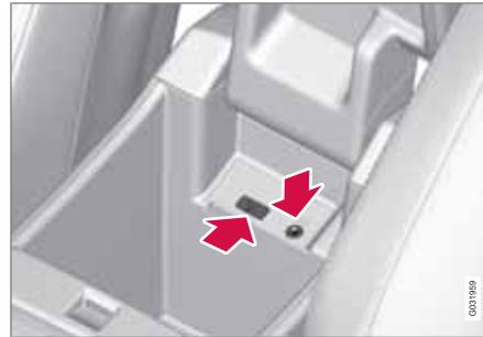
*Para conectar una fuente de sonido externa al sistema de información y entretenimiento del automóvil, utilice la conexión USB\* o la entrada AUX de la consola central.*
