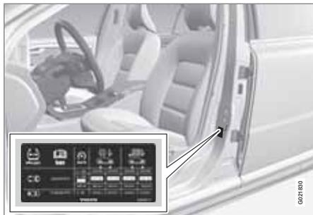
La placa de presión de neumáticos situada en el montante de la puerta del lado del conductor (entre la puerta delantera y la trasera) especifica la presión que deben tener los neumáticos en diferentes condiciones de carga y velocidad. Esos datos se indican asimismo en la tabla de presiones de neumáticos, ver la página 320.
