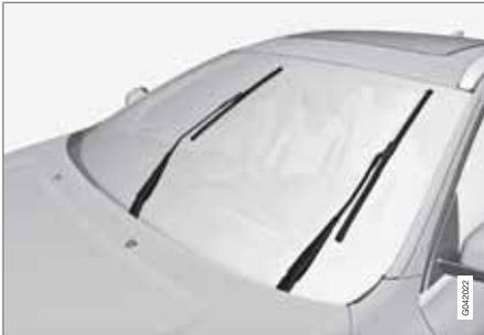
Para poder cambiar, lavar o levantar las escobillas (para extraer el hielo del parabrisas), éstas deben estar en posición de servicio.
