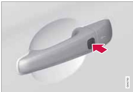
Los automóviles con el sistema "Keyless" tienen un botón en el tirador exterior de las puertas.
