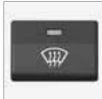
Se utiliza para eliminar rápidamente el vaho y el hielo del parabrisas y las ventanillas laterales. El aire se envía hacia las ventanillas. Cuando la función está conectada, se enciende la luz del botón del
