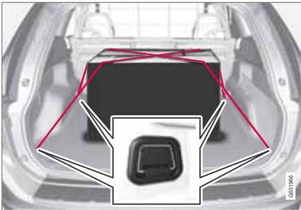
Las anillas plegables se utilizan para fijar correas que afiancen la carga en el compartimento de carga.
