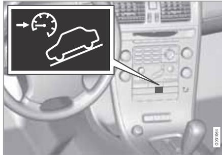
La función HDC se conecta y desconecta con un interruptor situado en la consola central. La luz del botón se enciende cuando la función está conectada. Cuando la función HDC actúa, se enciende el símbolo
