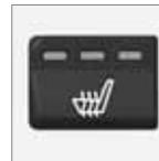
Con una pulsación del botón, se obtiene el máximo nivel de calefacción – se encienden tres luces.
