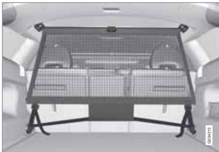
La red de protección se monta en cuatro puntos de fijación.
