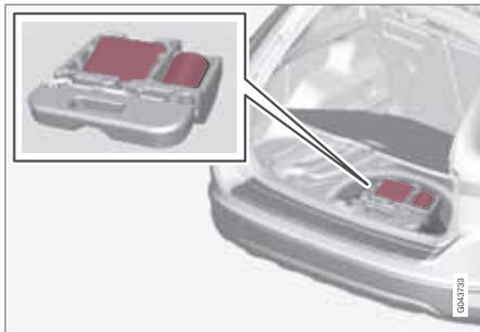
El sistema de reparación provisional (TMK; Temporary Mobility Kit) se utiliza para reparar un pinchazo y comprobar y regular la presión de los neumáticos. Consta de un compresor y un recipiente con líquido sellador. El kit sirve de reparación provisional. El frasco con el sellador debe cambiarse antes de llegar a la fecha de caducidad y después de utilizarse.
