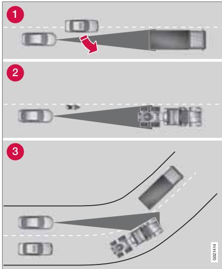
El ACC no detecta vehículos pequeños (Triángulo oscuro: campo de visión del ACC).
