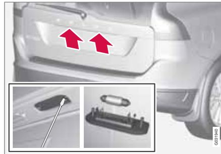
1. Suelte los tornillos con un destornillador.
