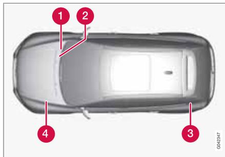
Ubicación de las cajas de fusibles en automóviles con volante a la izquierda. Si el automóvil lleva el volante a la derecha, cambia de lado la caja de fusibles situada debajo de la guantera.
