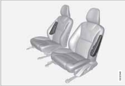
En una colisión lateral, el sistema SIPS (Side Impact Protection System) distribuye una gran parte de la fuerza de colisión a los largueros, los montantes, el piso, el techo y otros componentes de la carrocería. Los airbags laterales, situados junto a las plazas del conductor y la del acompañante, protegen el pecho y las caderas y son una parte importante del sistema SIPS.
