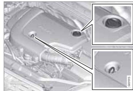
Varilla de nivel<sup>1</sup> y tubo de llenado, motor diésel.
