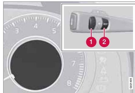
1. Gire la rueda selectora (1) hasta que aparezca el menú **DSTC**. **DSTC ON** significa que la función del sistema no ha sufrido cambios.
