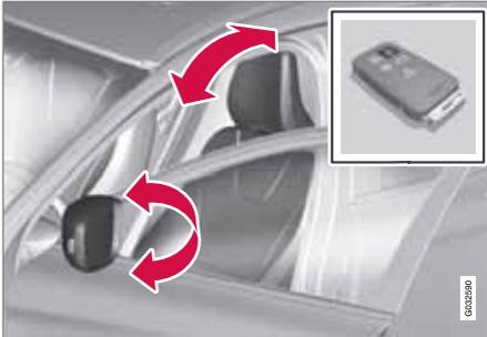
Cuando se abre el vehículo con la misma llave con la que se cerró y se abre la puerta del conductor, el asiento del conductor y los retrovisores exteriores adoptan automáticamente los ajustes almacenados en la memoria de la llave.
