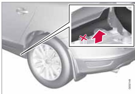
Compruebe que el gato esté debidamente colocado en el punto de apoyo, según la figura y que el pie está colocado vertical debajo del punto de apoyo.
