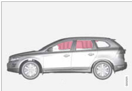
El airbag de techo lateral (IC - Inflatable Curtain) forma parte del sistema de airbags. El sistema IC está instalado a lo largo de ambos lados del techo interior y protege a las personas que ocupan las plazas laterales del automóvil. En caso de una colisión de suficiente intensidad, los sensores reaccionan y el airbag de techo lateral se infla. La cortina inflable contribuye a impedir que conductor y los acompañantes golpeen la cabeza contra el interior del automóvil al producirse una colisión.
