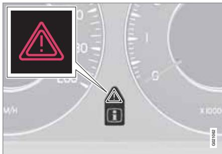
Si el automóvil ha sufrido una colisión, puede aparecer el texto **Modo seguridad Ver manual** en la pantalla de información. La aparición de este mensaje significa que ha disminuido la funcionalidad del vehículo. El modo de seguridad es una función de seguridad que se activa cuando existe la posibilidad de que la colisión haya dañado una función importante del automóvil como, por ejemplo, conductos de combustible o sensores de alguno de los sistemas de seguridad o del sistema de frenos.
