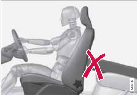
*No coloque en el asiento trasero objetos que puedan impedir el debido funcionamiento del sistema WHIPS.*
