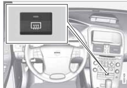
Utilice la calefacción eléctrica para eliminar la escarcha y la humedad de la luneta trasera y los retrovisores exteriores.
