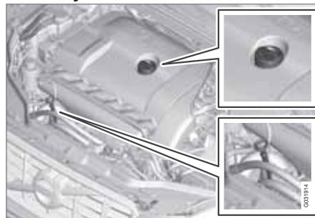
Varilla de nivel y tubo de llenado, motor de gasolina.
