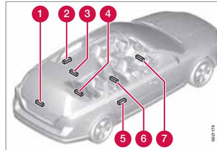
El sistema "Keyless" tiene una serie de antenas integradas distribuidas en el vehículo:
