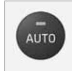
La función Auto regula automáticamente la temperatura, el aire acondicionado, la velocidad del ventilador, la recirculación y la distribución del aire.
